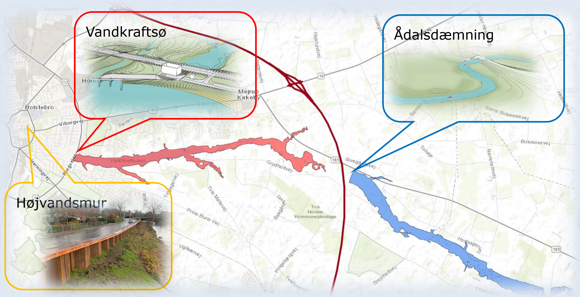
Den valgte løsning – tre elementer - Storå Klimatilpasningsprojekt
