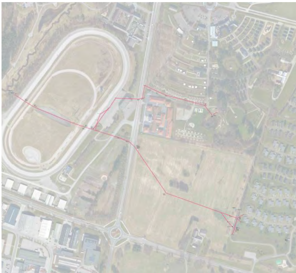
Figur 1.2.1.1: Eksisterende hoveddræn fra Lalandia til Billund Bæk, mod nord tilløbet fra Legoland Holiday Village.
