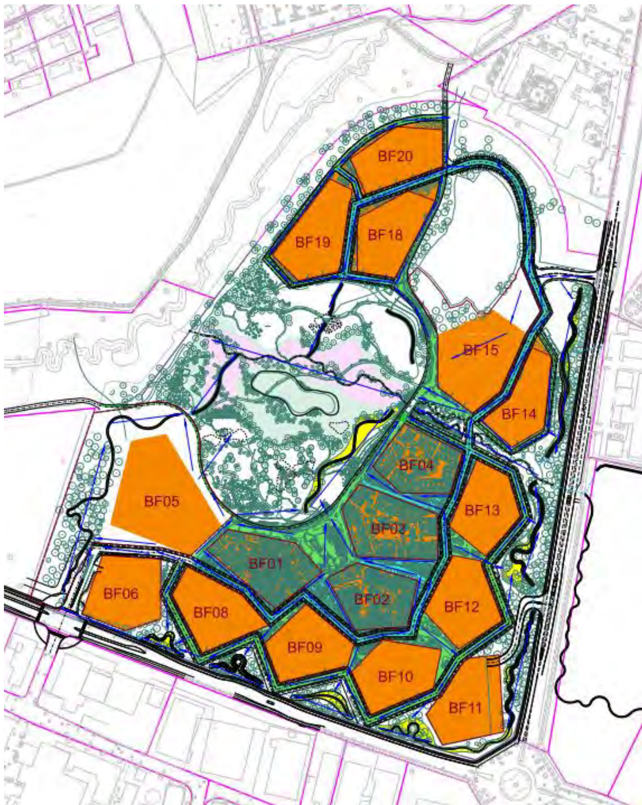
Figur 1.2.3.1: Illustration af vandhåndtering i Travbyen. I de orange byggefelter forsinkes og nedsives regnvand op til 1 års hændelse. I Lokalgaden og byrum tæt herpå, hvor der kan være midlertidig parkering, nedsives regnvand op til 10 års hændelse, langs Playline og Perifergade nedsives regnvand op til en 5 års hændelse. I grøfterne nedsives vand fra
