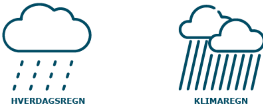
Figur 1.4.1.1: Der skelnes mellem hverdagsregn, der i middel optræder hvert 5. år og klimaregn, der ligger derover. Billund Kommune ønsker, at Travbyen klimasikres op til en 100 års hændelse.
